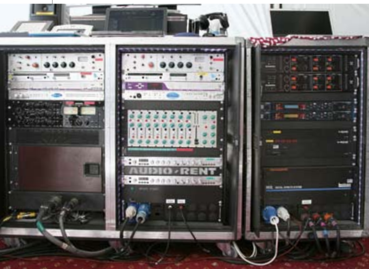
In alto: Il rack outboard della regia FoH.
