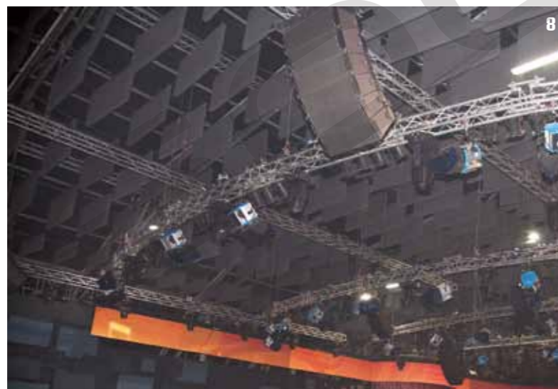
9_ Uno degli array di subwoofer composti da otto K1-SB, con i quattro sub da 18" appoggiati sotto.
